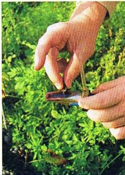
Links: Der Zuckergehalt der Weintrauben, der Öchsle-Grad, wird optisch mit einem Refraktometer bestimmt
